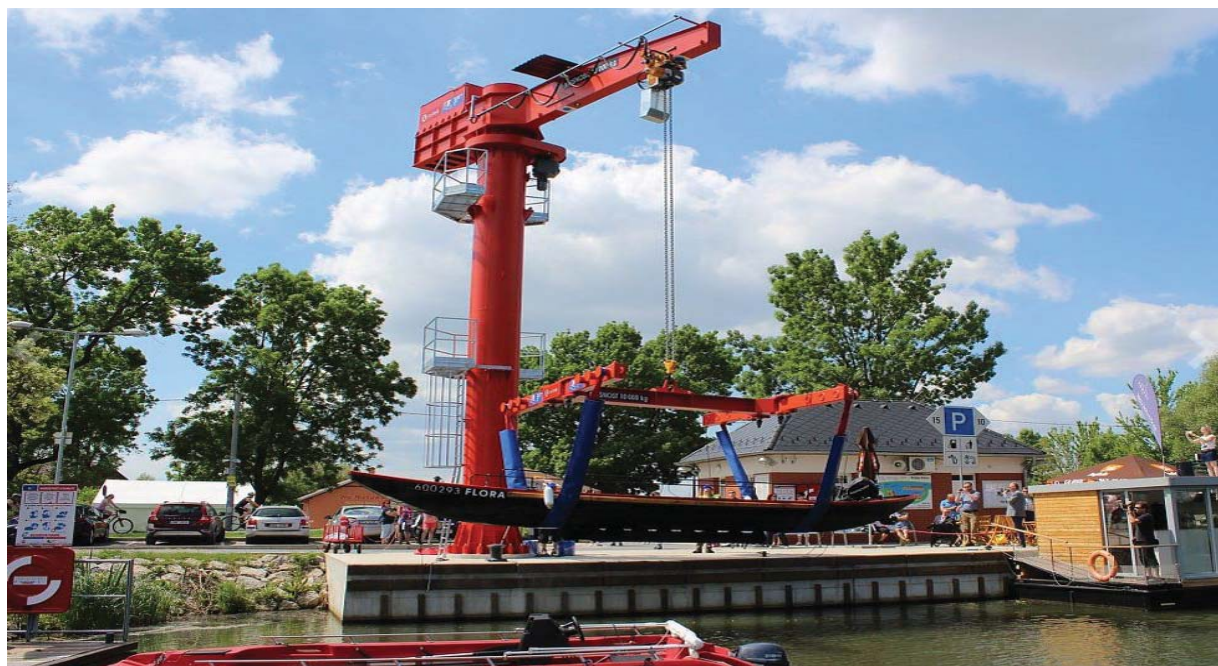
Nový stacionární jeřáb na vytahování až desetitunových plavidel na souš
